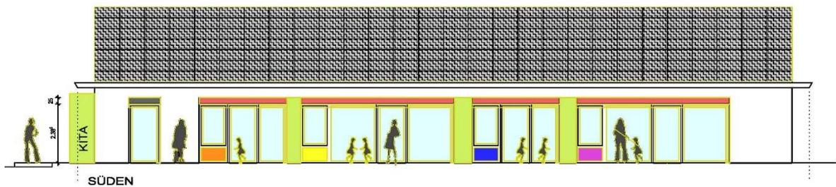
PV Anlage mit 196 Module und einer Gesamtleistung von ca. 47,0 kWp
