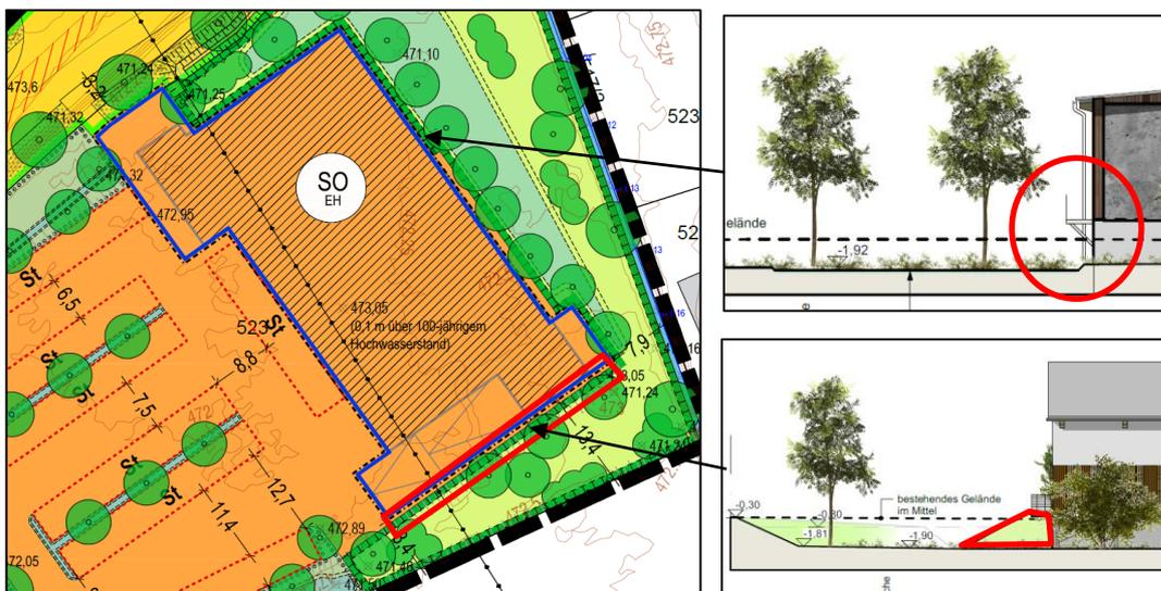
Abbildung 3: zusätzlicher Retentionsraum
