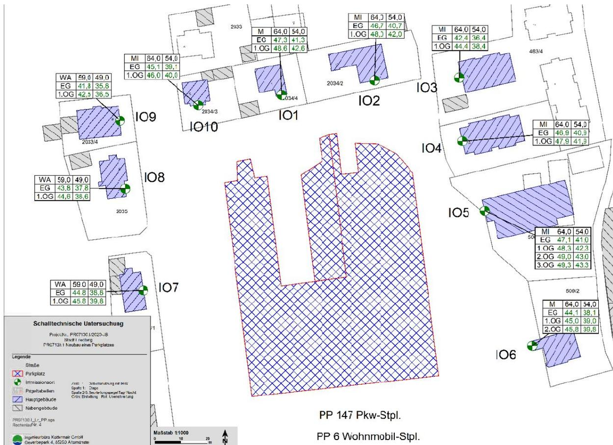
Abb. 4: Verkehrslärm Parkplatz - Anlage der Schalltechnischen Untersuchung (IB Kottnermaier 2020)
