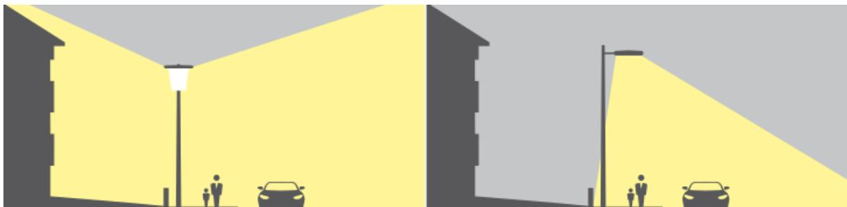
Moderne LED Leuchten projizieren das Licht mit Hilfe von Linsen- oder Spiegeltechnik direkt auf die Straße. Dadurch wird eine erhebliche Reduktion von unerwünschtem Streulicht erreicht. Die Kontrastschärfe auf der Verkehrsfläche wird erhöht.
